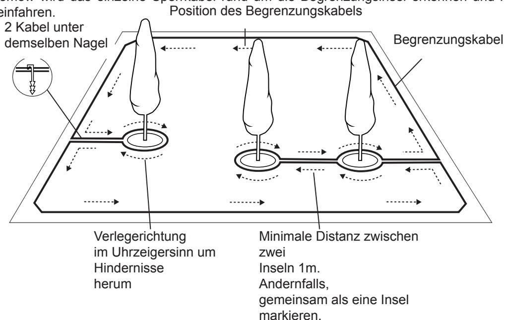
**VORSICHT!** Das Installieren des Begrenzungskabels im umgekehrten Uhrzeigersinn um das Hindernis wird dazu führen, dass Robomow in die Insel hineinfahren wird.
