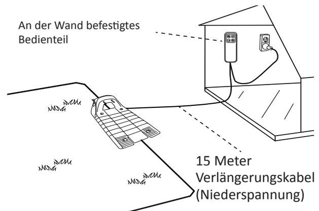
**Das Netzteil ist für Außenanwendungen geeignet. Dennoch sollte es an einer geschützten, trockenen und gut belüfteten Stelle montiert werden. Das Bedienteil sollte nicht direktem Sonnenlicht oder Regen ausgesetzt sein.**
