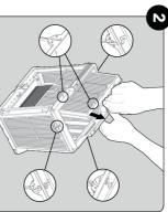
Die Platten in der folgenden Reihenfolge demontieren: 2 ---> 3 ---> 4.
